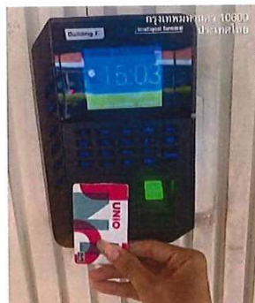
รูปที่ 42 ระบบคีย์การ์ดเข้าอาคาร
